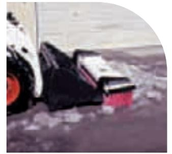
Quando utilice la barredora, use un aspersor para reducir la emisión de polvo (adaptable también a fresadoras, compactadores vibrantes, barredoras orientables, etc.). Una bomba eléctrica suministra agua a las boquillas del implemento.
